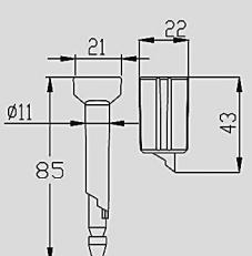
پلمپ فشنگی با درجه حفاظت "خیلی خوب" قابلیت چاپ شماره سریال، نام و آرم به روش لیزر و هات استمپ ماده اولیه: بدنه فولادی آبکاری شده با روکش ABS میانگین استحکام کشش: ۴۵۰ کیلوگرم بسته بندی: وکیوم های ۱۰ عددی / در هر کارتون ۲۰۰ عدد کاربردها: پلمپ درب انبارها، کانتینر، کامیون، تانکر بونکر، واگن های بار و سوخت و ...
