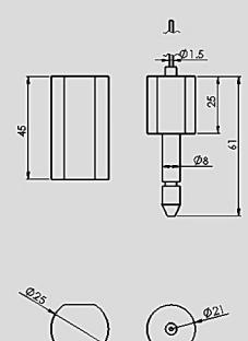
پلمپ ترکیبی با قابلیت تنظیم فاصله پلمپ و درجه حفاظت "خیلی خوب" قابلیت چاپ شماره سریال، نام و آرم به روش لیزر و هات استمپ ماده اولیه: بدنه آلومینیم با روکش پلی پروپیلن و کابل فولادی به قطر ۱/۵ میلی متر میانگین استحکام کشش: ۳۰۰ کیلوگرم بسته بندی: وکیوم های ۱۰ عددی / در هر کارتون ۲۰۰ عدد کاربردها: پلمپ درب انبارها، کانتینر، کامیون، تانکر بونکر، واگن های بار و سوخت و ...
