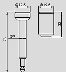
پلمپ فشنگی با درجه حفاظت "خیلی خوب" قابلیت چاپ شماره سریال، نام و آرم به روش لیزر و هات استمپ ماده اولیه: بدنه فولادی آبکاری شده با روکش ABS میانگین استحکام کشش: ۴۵۰ کیلوگرم بسته بندی: وکیوم های ۱۰ عددی / در هر کارتون ۲۰۰ عدد کاربردها: پلمپ درب انبارها، کانتینر، کامیون، تانکر بونکر، واگن های بار و سوخت و ...
