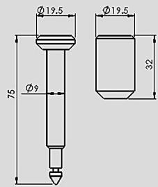
پلمپ فشنگی با درجه حفاظت "خیلی خوب" قابلیت چاپ شماره سریال، نام و آرم به روش لیزر و هات استمپ ماده اولیه: بدنه فولادی آبکاری شده با روکش PP میانگین استحکام کشش: ۴۵۰ کیلوگرم بسته بندی: وکیوم های ۱۰ عددی / در هر کارتون ۲۰۰ عدد کاربردها: پلمپ درب انبارها، کانتینر، کامیون، تانکر بونکر، واگن های بار و سوخت و ...
